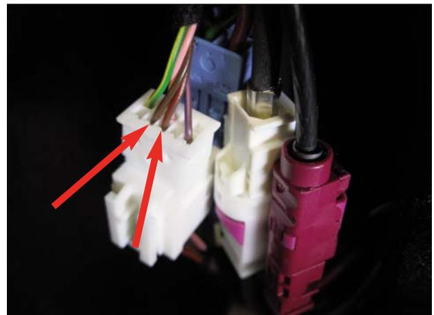
**N.B. Eseguire questa connessione solo con batteria vettura scollegata. Una errata connessione di questi cavi, può compromettere il funzionamento della vettura.**
